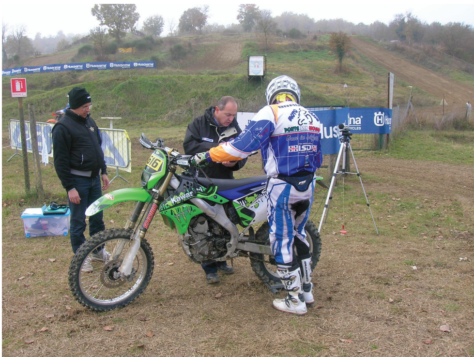
Figura 3.2.2 – Prova fonometrica allo scarico con metodo 2mMax
