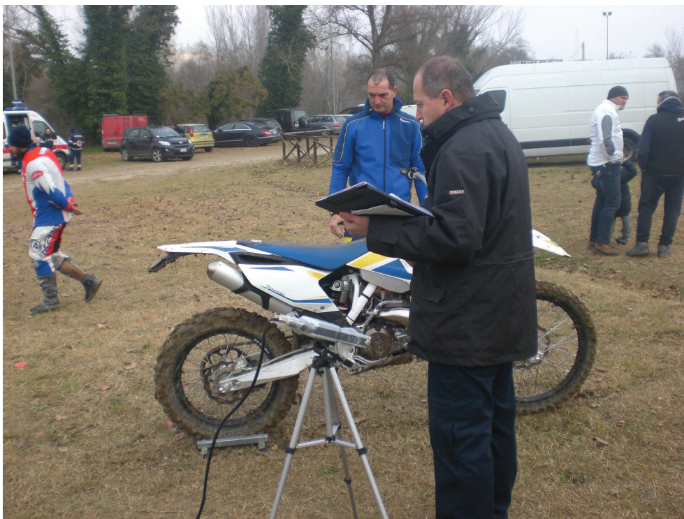
Figura 3.2.1 – Prova fonometrica allo scarico su moto Husqvarna con metodo 2mMax
