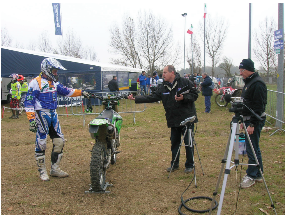
Figura 3.2.3 – Prova fonometrica allo scarico con metodo 2mMax
